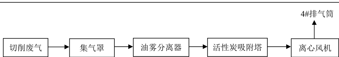
图 6 切削废气收集处理流程图
